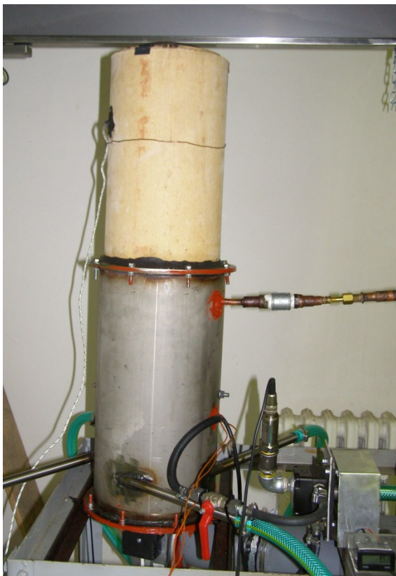
Obrázok 1: Experimentálny horák
