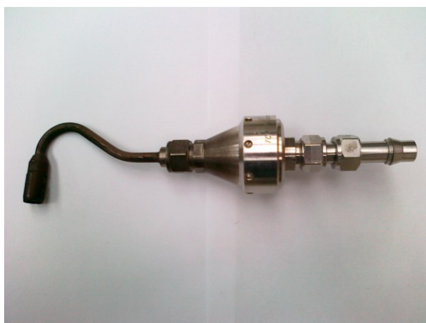
Obrázok1: Odberová sonda na odber TZL
