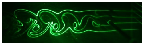
Obrázek 4: Vírová stezka za válcem při Re cca 96
