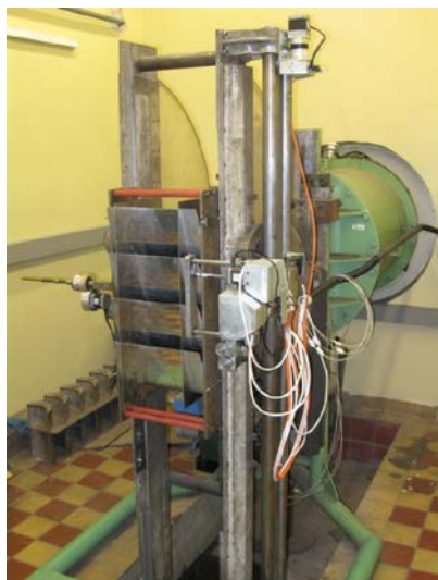
Obr. 1: Výstupní dýza tunelu osazená lopatkovou mříží
