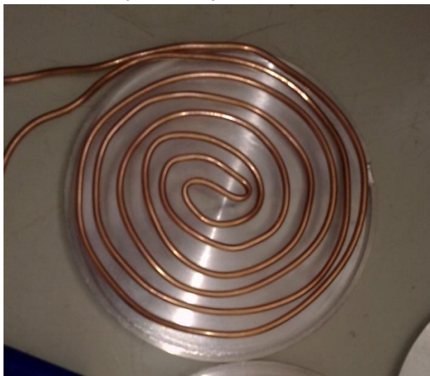
Obr. 2: Uloženie kapilárnej rúrky v termoplatni
