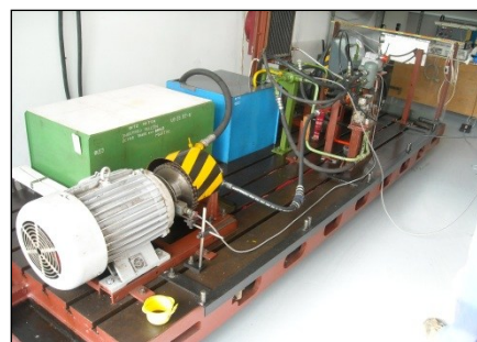
Obrázok 4: Skúšobné zariadenie pre zrýchlené skúšky životnosti
