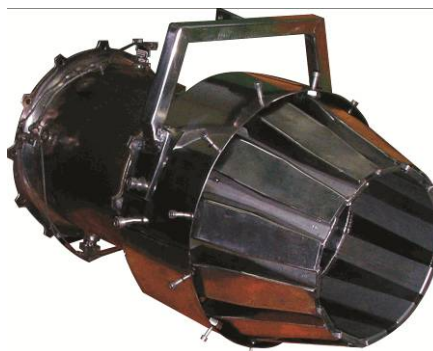
Obr. 1 LIRSLM + výstupné ústrojenstvo malého prúdového motora MPM-20 s plynule meniteľným výstupným prierezom.
