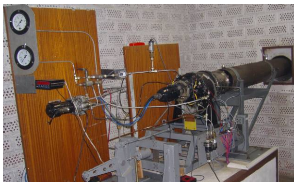
Obr. 1 LIRSLM + výstupné ústrojenstvo malého prúdového motora MPM-20 s plynule meniteľným výstupným prierezom.
