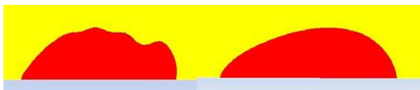
Obrázek 5: Tvary kapek při výpočtu se standardní stěnovou funkcí (vlevo) a s dvouvrstvě modelem Enhanced Wall Treatment (vpravo)
