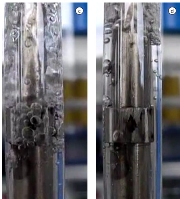
Obrázek 6: Příklad varu v bodě (c), (d)
