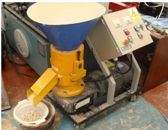
Obrázok 2: Experimentálny peletovací lis
